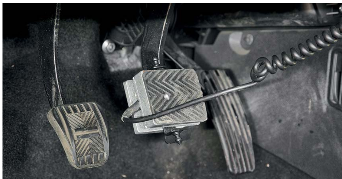
Тензометрический датчик, измеряющий усилие на педали тормоза, — главный инструмент для оценки колодок на автомобиле
